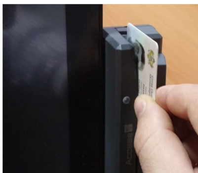
El. uređaj za identifikaciju birača i način provlačenja lične karte / pasoša kroz MRZ čitač
