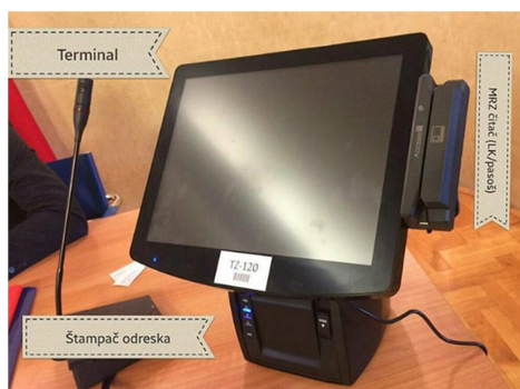
El. uređaj za identifikaciju birača i način provlačenja lične karte / pasoša kroz MRZ čitač
