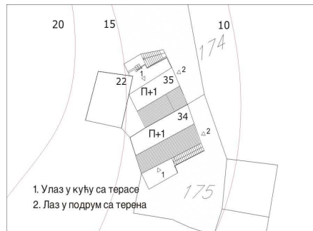
Dvojne kuće postavljene upravno na izohipse
