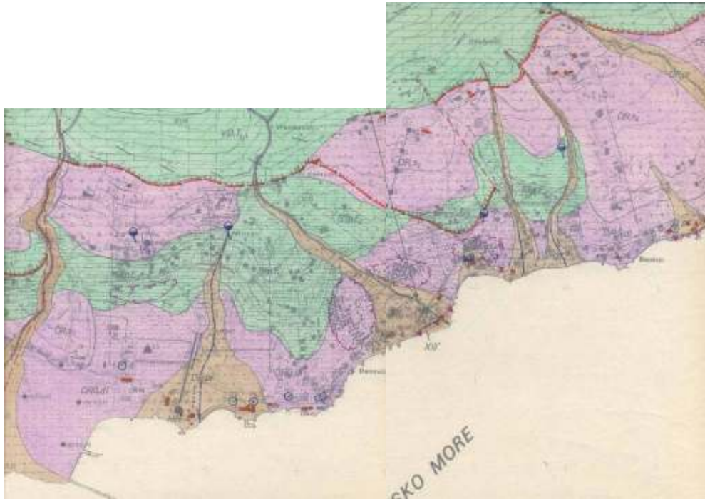
Sl.2. Litografska svojstva tla, sa označenim izvorima i kaptazama (bunari su predstavljeni krugom sa tačkom, prirodni izvori krugom i „repom“, a kaptirani izvori pravougaonikom).
